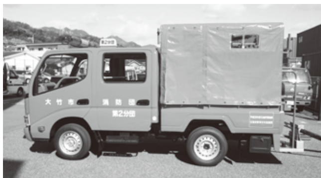
小型動力ポンプ付消防車
