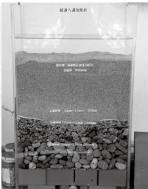
ろ過池の砂利層の断面。上から下にかけて、きめ細かいものから粗いものになっていく。
