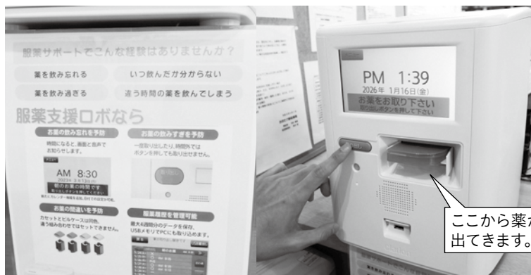
【服薬支援ロボット】高齢者や認知症の方の薬の飲み忘れ、飲み過ぎ、飲み間違いを防止するための機器。設定した時間に音声や画面で服薬を知らせてくれます。
