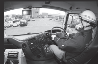
運転席のパネルは、操作しやすいように運転者のほうに向けて配置されている。車両の全方向を確認できるカメラ、モニターも装備。
