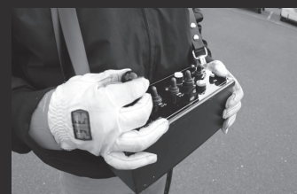
消火薬液や水を放水する電動放水銃。リモコンで遠隔操作ができる。
