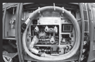
車体の側面には、ホースなどの資機材を収納。シャッターで覆われ安全性を高めている。
