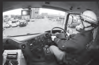
運転席のパネルは、操作しやすいように運転者のほうに向けて配置されている。車両の全方向を確認できるカメラ、モニターも装備。
