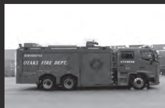
消火薬液や水を放水する電動放水銃。リモコンで遠隔操作ができる。
