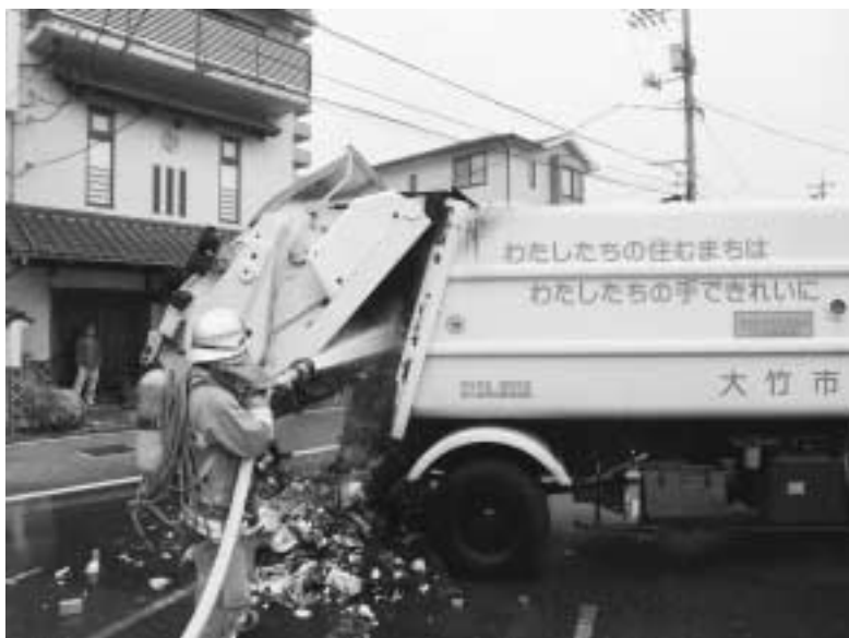
スプレー缶により火災を起こしたごみ収集車
