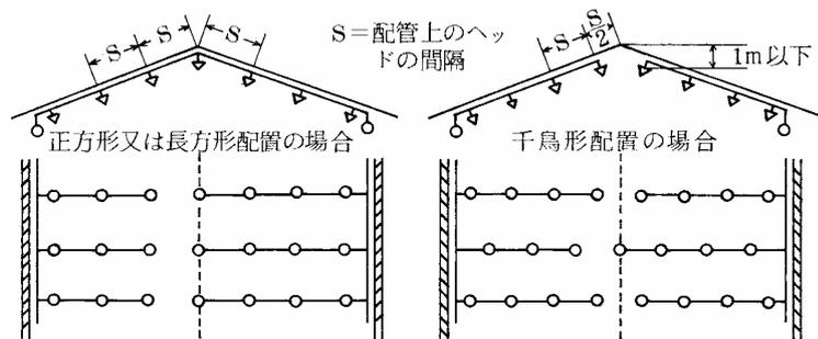
イ ヘッドを取付ける面の傾斜が1分の1（45°）を超えるもので当該屋根又は天井の頂部にヘッドを設ける場合は、次図の要領により当該屋根又は天井とヘッドとの水平離隔距離を60cm以上とすることによ
