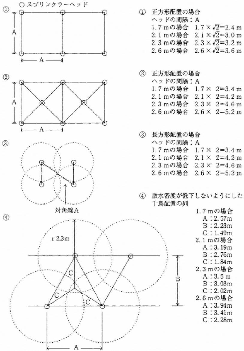
図3-2 閉鎖型スプリンクラー設備の構造図例
