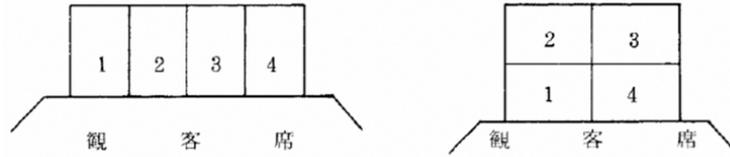
ウ 2以上の放水区域の境界付近において火災が発生した場合に、どちらか一方の放水区域を放水することにより消火が可能であるようにしておくことが必要のため、隣接する放水区域の相互重複は、次によるものとする。ただし、逆止弁方式のものは、点検困難なため用いないこと。◆
