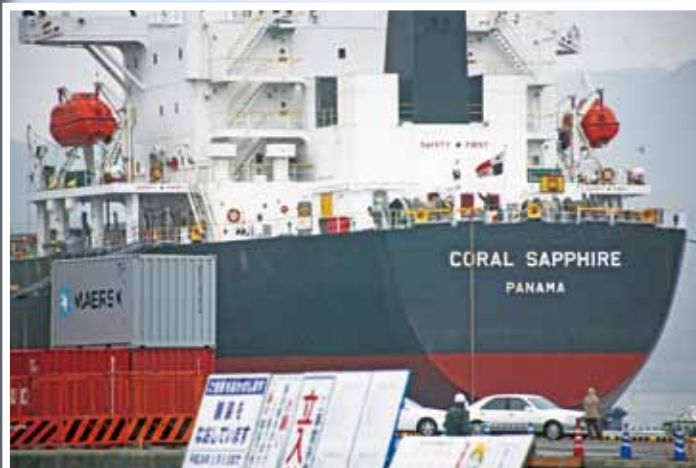
H24.3.16 大竹港入港 CORAL SAPPHIRE号 (全長225m 型幅33m 積載重量78,000t)
