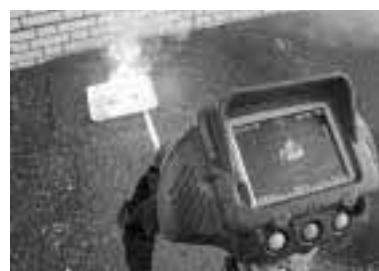
熱源から発生する赤外線を検知し、数百度までの温度を画像表示します。
