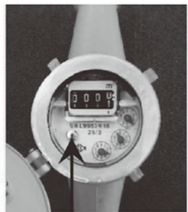
水道メーターのパイロットマーク（羽根車）通水時は回転します。
